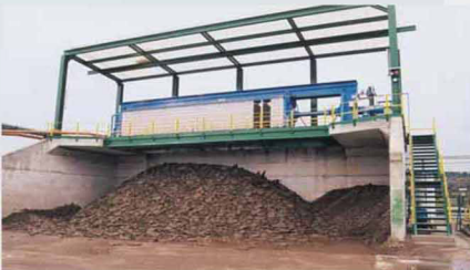
استفاده از فیلتر های ممبرانی جهت خروج گل حاصل از شست و شوی چغندر
